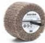
El minicepillo laminado Clean & Finish Scotch-Brite™ es un abrasivo de óxido de aluminio unido a un núcleo de fibra. Nuestros cepillos laminados incorporan una estructura de malla tridimensional que es flexible, suave y plegable para obtener acabados de superficie uniformes sin marcas por vibración.
