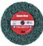
El disco Scotch-Brite™ Roloc™+ Clean and Strip XT Pro Extra Cut cuenta con un mineral abrasivo de óxido de aluminio incorporado en una malla de nylon abierta. Nuestros discos están diseñados para eliminar revestimientos duros, como capas gruesas de óxido o pintura, y corrosión, al mismo tiempo que homogeneizan y refinan el metal a la vista subyacente.
