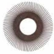
El disco de reemplazo para cepillo radial Bristle Scotch-Brite™ está formado por cerdas flexibles moldeadas llenas con grano abrasivo cerámico de 3M™. Hemos diseñado las cerdas para que sean flexibles pero firmes con objeto de que puedan llegar hasta los contornos y ofrecer un acabado de alta calidad en todas las superficies ejerciendo una mínima presión.
