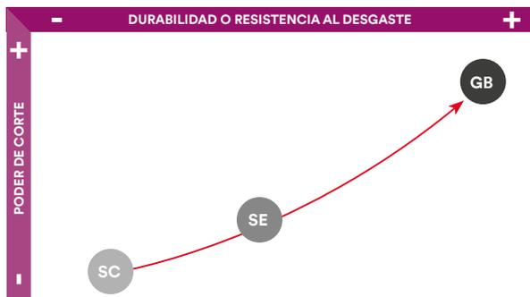
El cuadro representa la capacidad de corte y resistencia al desgaste de los diferentes discos.
