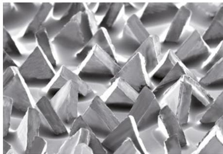
El grano de forma triangular está orientado electrostáticamente con vértice hacia arriba, actuando cada uno como una herramienta de corte sobre el metal; el desgaste uniforme proporciona una vida larga y acabados consistentes a cualquier presión de lijado.
