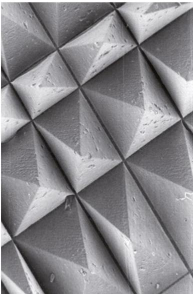
Estos abrasivos tienen una construcción micropiramidal. Cada pirámide está compuesta por una mezcla de resina y mineral de tal forma que, a medida que se produce el desgaste del abrasivo van apareciendo siempre granos de mineral nuevos, que facilitan el lijado. Gracias a esta característica, obtenemos un rendimiento constante y un acabado predecible.
