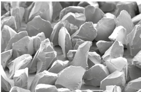
Debido a su diseño en forma triangular, Cubitron™ II no puede ser clasificado en ninguno de los sistemas actuales. Se trata de un grano abrasivo de precisión, más grande, más rápido y más duradero que los clasificados por el sistema ANSI gracias al corte limpio que proporcionan a través del metal.
