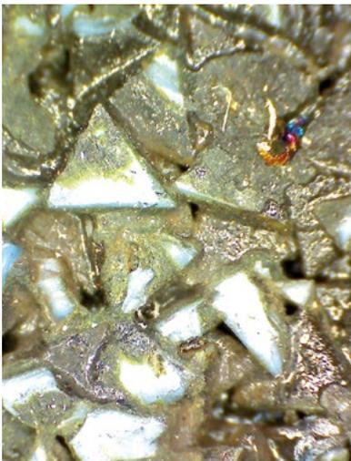
Mucho más que un abrasivo, su forma triangular de granos cerámicos orientados sobre el soporte y con puntos de corte de gran resistencia, hacen de este mineral el nuevo referente. La revolución ha llegado al mundo del abrasivo.
